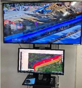
現場事務所には2台のモニターがあり、上にWEBカメラの映像と下に施工履歴管理システムを映しています。WEBカメラは現場の見た場所を指定することができます。施工履歴管理システムは点群データに計画設計データを表示することができ、現状と計画との差を色で表現しており、好きな横断データも表示できるほか重機の位置や施工状況も平面上でリアルタイムで知ることができます。
